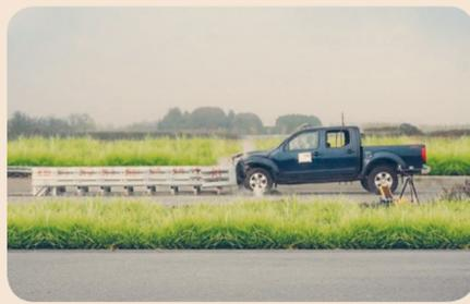
Crash test alla velocità di 100 km/h con pick-up di 2000 kg. All'interno del veicolo è posizionato un manichino di tipo HYBRID III 50 percentile
